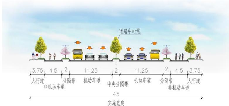
图 2-21 泰顺路（姜高路-海军大道段）地面道路标准段横断面布置图
