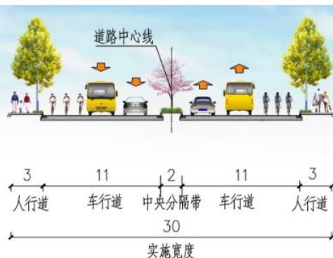
图 2-17 泰融路（姜高路-沪渝蓉铁路段）横断面布置图
